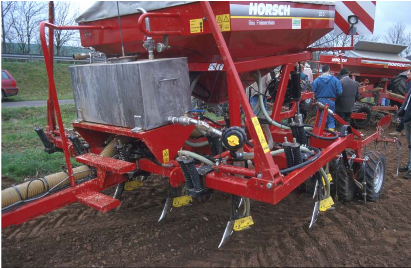
HORSCH Airseeder CO 3 mit Duett-Scharen zur platzierten N-Düngung bei Mulchsaat Foto: Stefan Weimar
