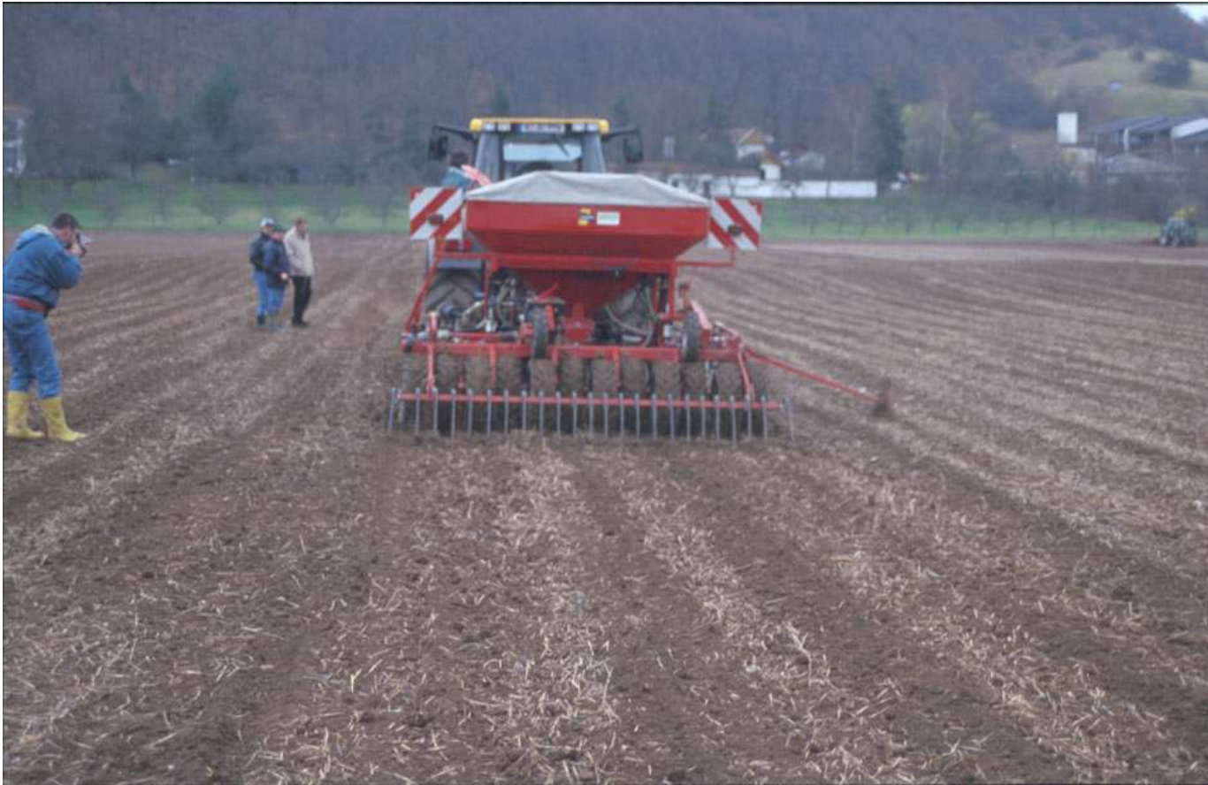
HORSCH Airseeder CO 3 mit Duett-Scharen Versuch zur Bodenbearbeitung (Bad Sobernheim)
