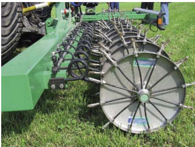
Injektortrad für die punktförmige Ammonium-Applikation bei Engreihenkulturen und Grünland. Die sternförmigen Injektornippel sind am Ende verschlossen. Der Flüssigkeitsaustritt erfolgt durch seitliche Öffnungen zum Zeitpunkt, in dem die Nippel in den Boden einstecken. Durch Pendelaufhängung und Federbelastung der Einzelaggregate wird eine gleichmässige Tiefenführung erreicht.
