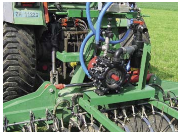
Die Membranpumpe und die Regelventile des Injektorgeträtes werden durch einen Mikroprozessor gesteuert. Die gewünschte Applikationsmenge kann so unabhängig von der Arbeitsgeschwindigkeit eingehalten werden. Die Schaummarkierung an den Radträgerenden ermöglicht bei allen Feldverhältnissen ein exaktes Anschlussfahren.
